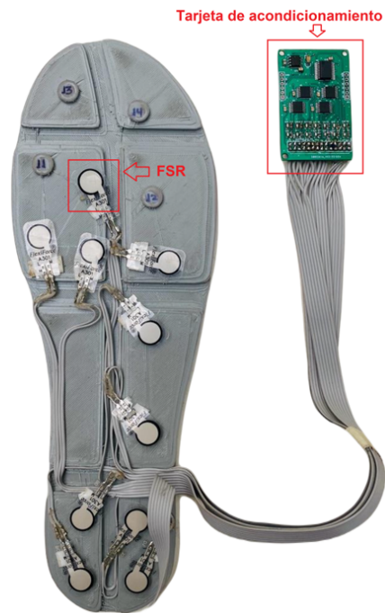
Figura 11. Conexión de sensores.
