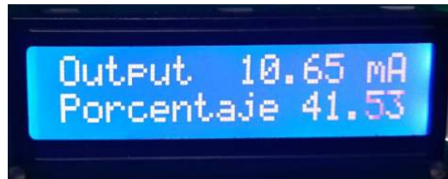
Fig. 9. Valores en el LCD del prototipo conectado a la válvula de pruebas. Adaptado de Centro Para la Industria Petroquímica, Regional Bolívar, 2017.
