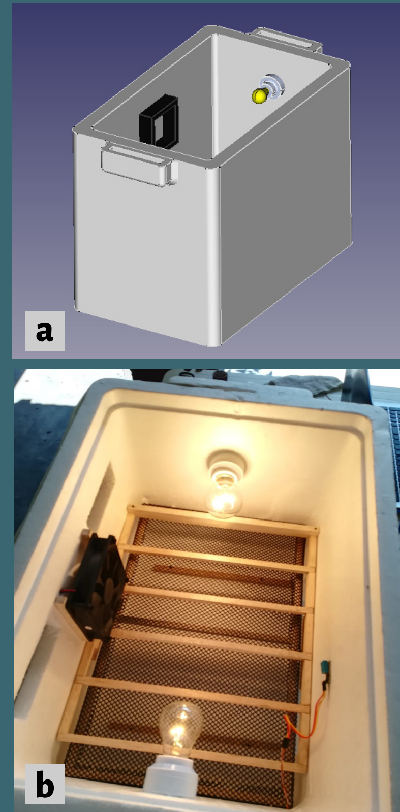
Figura 1. a. Diseño 3D de la incubadora, b. Prototipo construido
