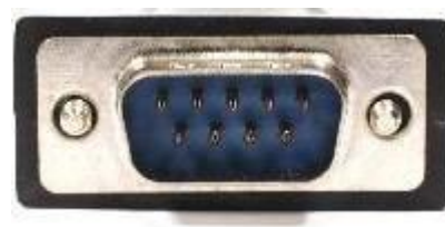
Figura 2, Foto conector 2 tipo DB9 del Ventilador Puritan Bennett
