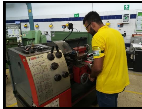
Ilustración 3- Fabricación de partes en torno convencional; Obtenido: Semillero de investigación.
