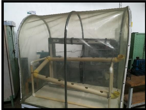
Ilustración 10- Invernadero con estructura para cultivo hidropónico y ducto de refrigeración; Obtenido: Semillero de investigación.
