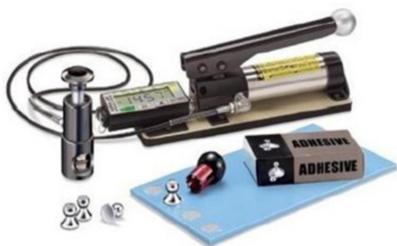
Figura 2. Equipo pull off para medidas de adherencia [5].
