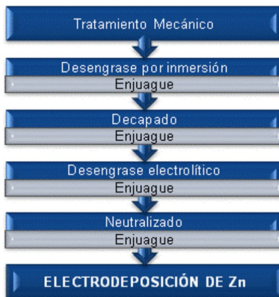
Figura 1. Etapas de la preparación superficial de muestras previas al galvanizado.
