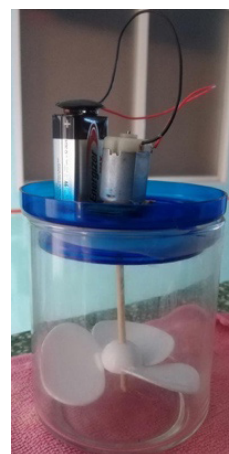
Figura 11. Montaje del biorreactor
