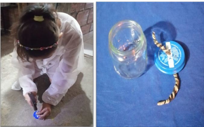
Figura 3 Diseño mechero de alcohol: A. Perforación de tapa. B. Elaboración mechero de alcohol.
