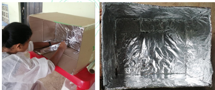
Figura 2 Diseño caja simuladora de flujo laminar: A. Montaje prototipo. B. Construcción caja simuladora de flujo laminar:
