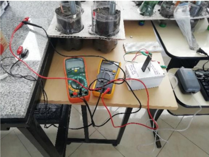
Figura 3. Montaje de la Celda de Combustible Microbiana.
