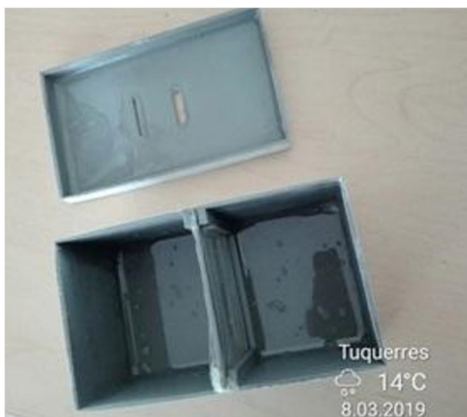
Figura 2. Celda de Combustible Microbiana impresa en ácido Poliláctico.
