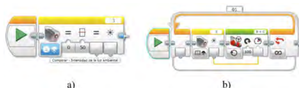
Figura 3. Programación del sensor de color en modo intensidad de luz ambiental en el software Lego Mindstorms Education EV3. a) Bloque de programación sensor modo intensidad luz ambiental. b) Programa implementado
