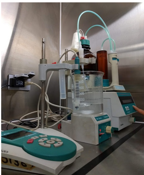
Figura 2. Montaje experimental para la realización de la curva de titulación
