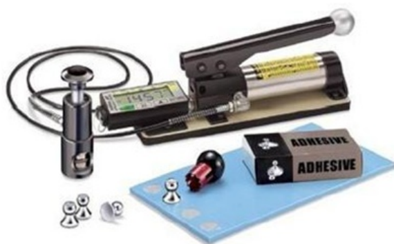
Figura 2. Equipo pull off para medidas de adherencia [5].
