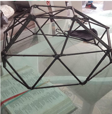
Figura 1. Prototipo domo Geodésico. Elaboración propia
