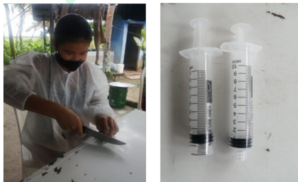
Figura 4 Diseño jeringa gramera: A. Corte de jeringa. B. Rediseño de jeringa
