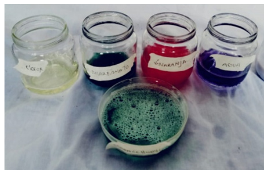
Figura 4. Colores que se obtienen al determinar el pH de manera cualitativa utilizando repollo morado. Fuente: Los autores
