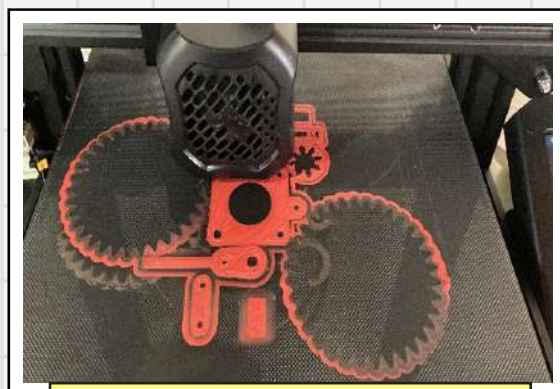
Figura 2: Fabricación de las piezas mecánicas con impresión 3D.
