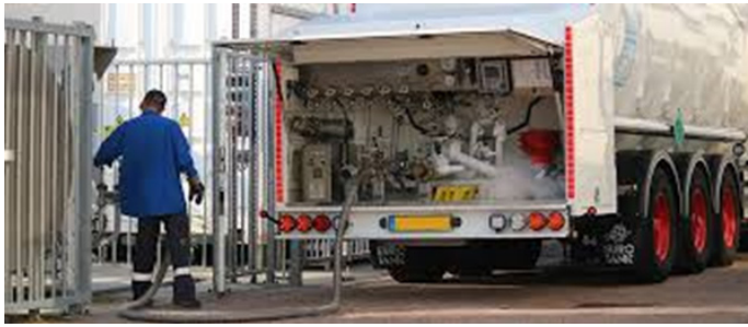
Figura 4. Esquema de la parte posterior de un camión cisterna de GNL (Ingersoll Rand, 2022)
