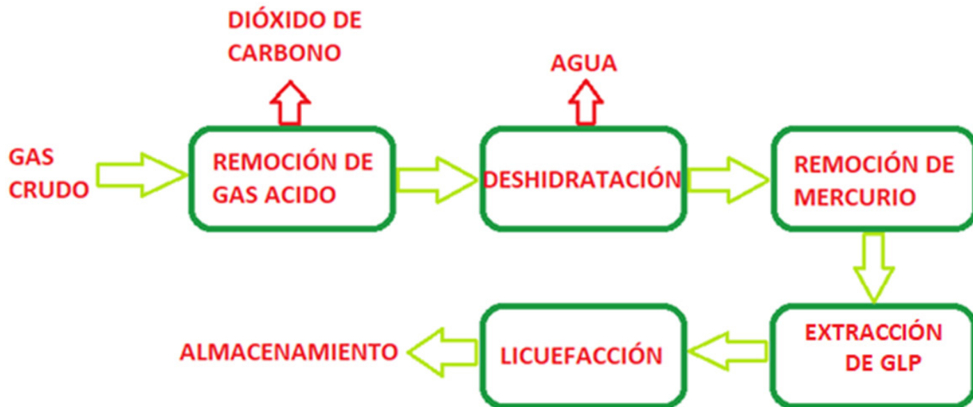
Figura 2. Flujo del proceso de licuefacción. Elaboración propia.
