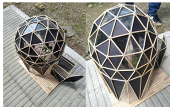
Figura 8. Prototipado rápido del Domo Geodésico. Fuente: Elaboración propia
