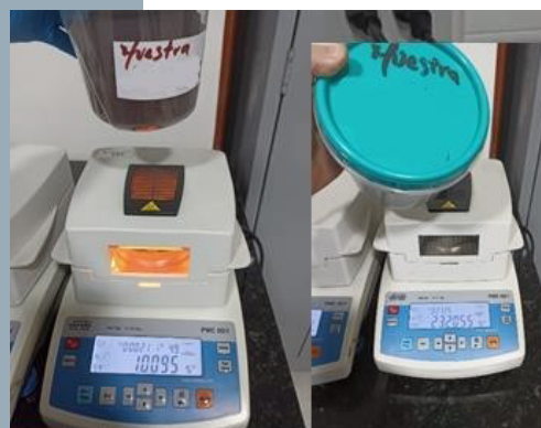
Figura 2. Medición de humedad
