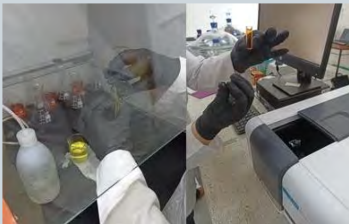
Figura 4. Preparación para medición de Carbono Orgánico Total
