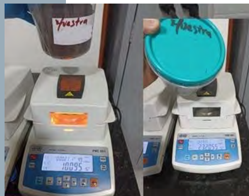
Figura 2. Medición de humedad
