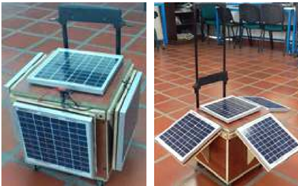
Figura 4. Portable Energy Modo “Cerrado para Traslado” y Modo “Abierto Generación”
