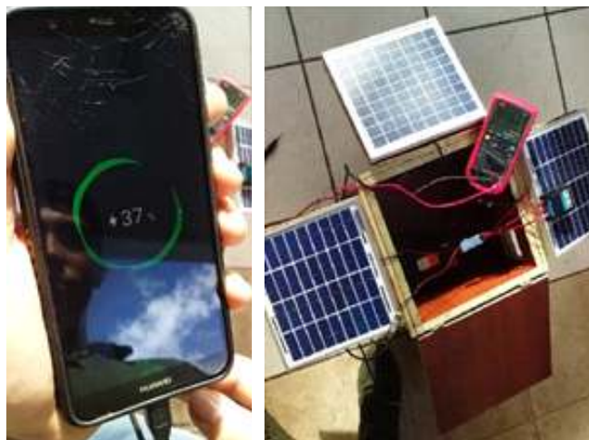
Figura 5. Prueba de carga de celular con Portable Energy.
