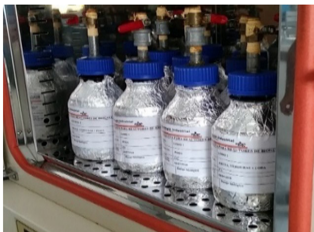
Figura 1. Reactores anaerobios a escala de laboratorio
