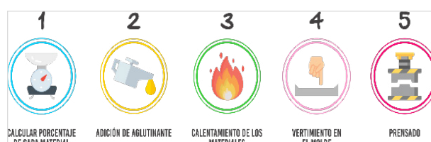
Figura 2. Proceso de elaboración de probetas.
