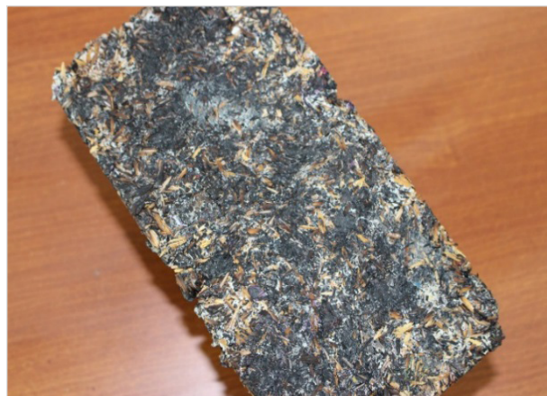
Figura 5. Primera probeta con cascarilla de arroz, hdpe y aceite lubricante.
