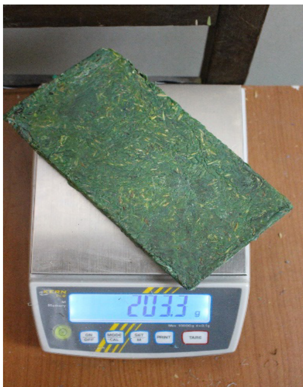
Figura 9. Peso de la probeta con cascarilla de arroz, hdpe previamente calentado y aceite de palma.
