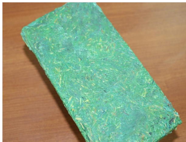
Figura 8. Probeta con cascarilla de arroz, hdpe previamente calentado y aceite de palma. Fuente: Elaboración propia
