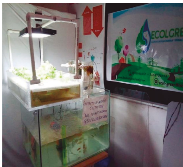
Figura 7. Sistemas acuapónico experimental en condiciones de laboratorio. Fuente: Elaboración propia.
