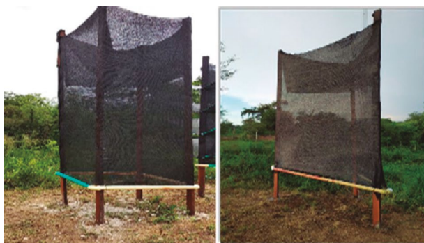
Figura 3. Prototipos de captación de la niebla construidos tipo cuadrado y tipo triángulo. Fuente: Elaboración propia.
