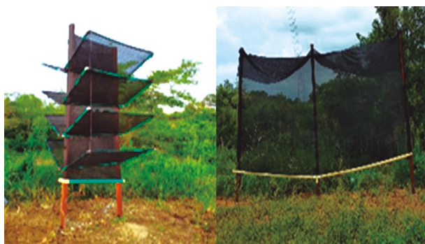
Figura 4. Prototipos de captación de la niebla construidos tipo pantalla y tipo árbol. Fuente: Elaboración propia
