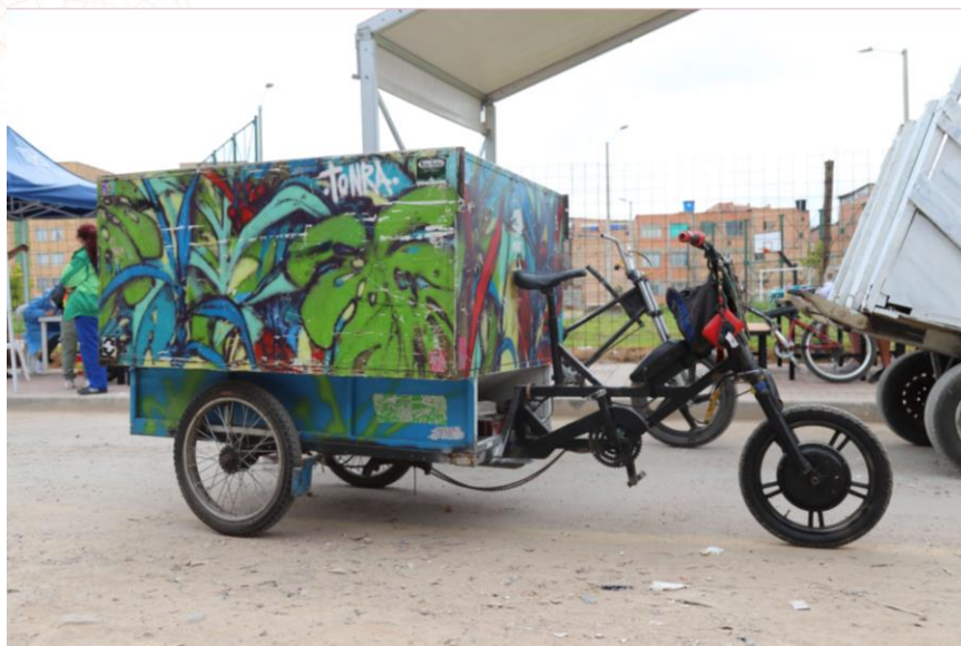
Figura 6. Sistema de Transporte de Reciclador en Bicicargueros, Tracción Humana
