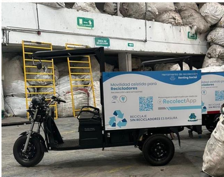
Figura 7. Sistema de Transporte de Reciclador en Motocargueros, Tracción Mecanizada Fuente https://gaiarec.org/index.php?view=article&id=48:programa-de-movilidad-sostenible-para-recicladores&catid=2
