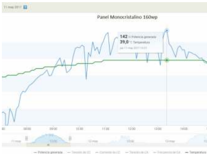
Figura. 6. Curva de potencia - temperatura de panel Monocrystalino con datos medidos del sistema de monitoreo.
