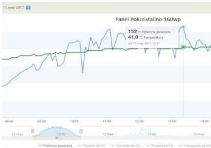
Figura. 5. Curva de potencia - temperatura de panel policristalino con datos medidos del sistema de monitoreo.
