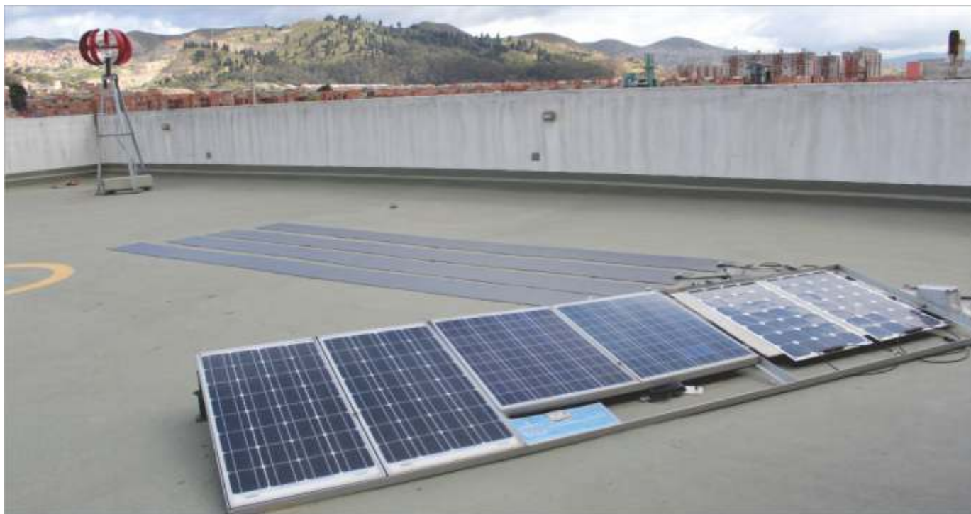
Figura. 1. Planta experimental para monitoreo de tecnologías fotovoltaicas " CTCM BOGOTÁ"
