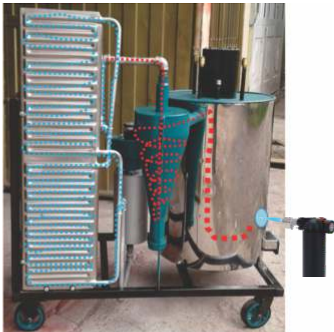
Figura 6. Pasos del proceso de gasificación
