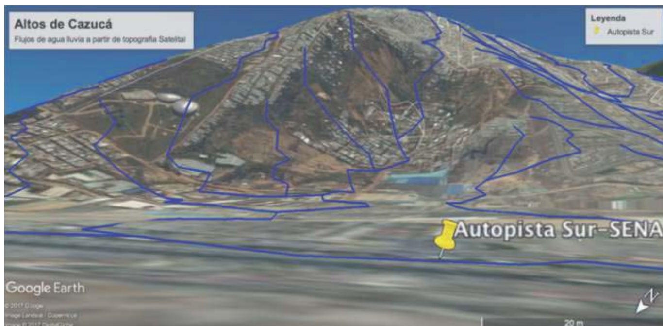
Figura 2. Flujos de agua de la montaña de Altos de Cazucá hacia la autopista Sur, analizados mediante el programa QGIS vistos desde Google Earth Pro 2017. Fuente: Elaborado por el autor, mediante un modelo de elevación digital SRTM procesado con SAGA GIS, visualizado en Google Earth Pro (2017).
