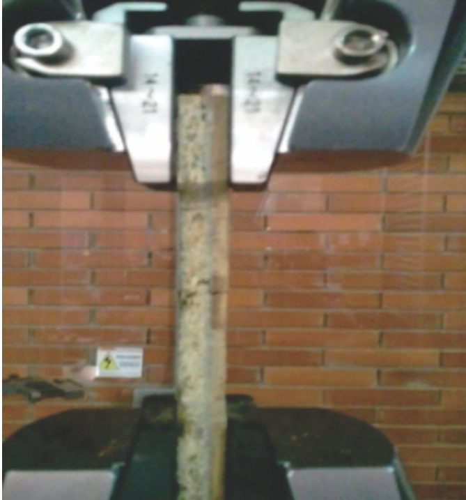
Figura 18. Prueba probeta de guadua C1. Fuente propia.
