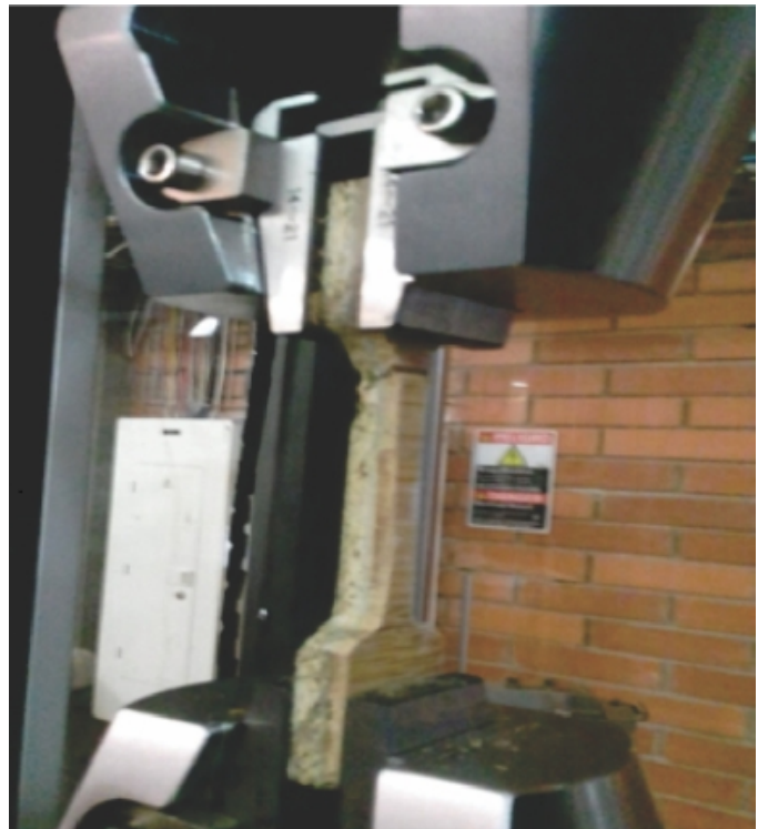
Figura 20. Prueba probeta de guadua C3. Fuente propia.
