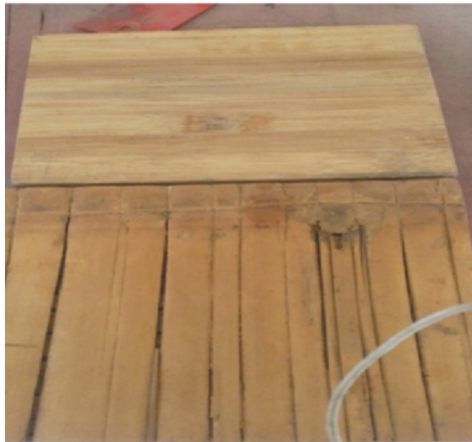
Figura 13. Tableros de 30 x30 cms, a partir de esterilla de guadua. Fuente propia.
