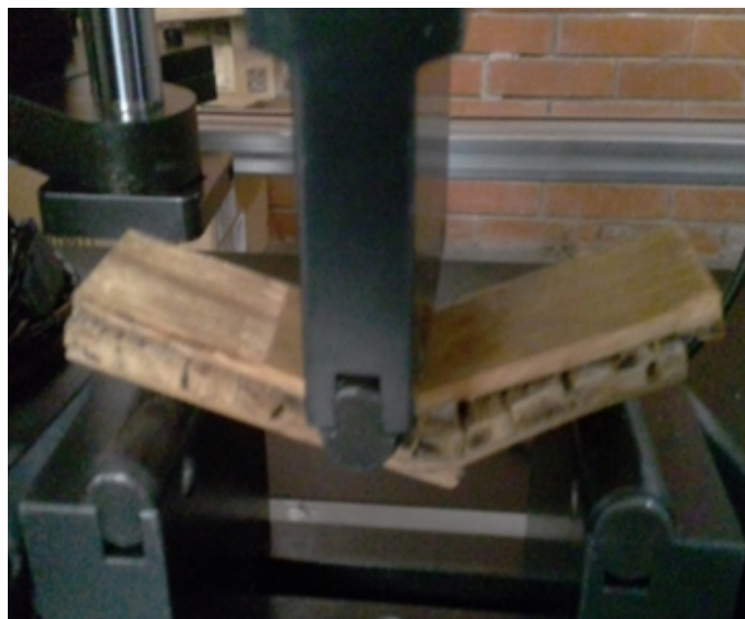
Figura 16. Prueba probeta de guadua B1. Fuente propia.
