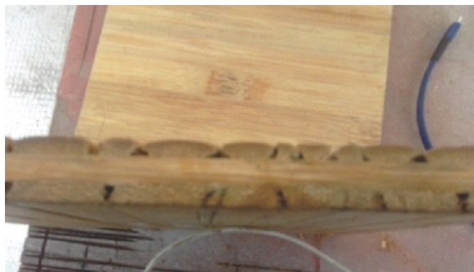
Figura 15. Tableros de 30 x30 cms, a partir de esterilla de guadua. Fuente propia.
