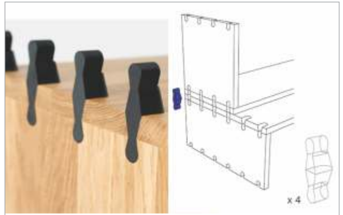
Ilustración 13 - Ejemplo de Empalme / Proyecto Arronde (Camille Ravanel - 2017)
