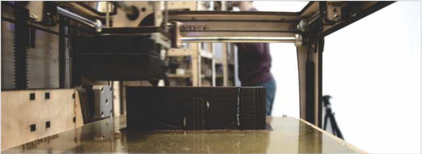
Ilustración 11 - Proceso de Impresión Kids Maker Chair.
