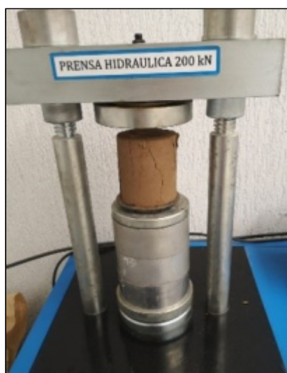
Figura 9. Resistencia a la compresión en mezclas de suelo – arcilla.
