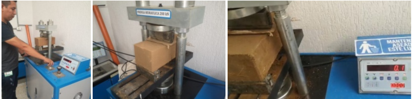
Figura 12. Ensayo de flexión a BTC de prueba
