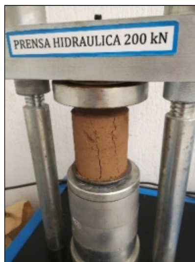
Figura 9. Resistencia a la compresión en mezclas de suelo – arcilla.
