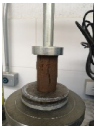
Figura 8. Esfuerzo Compresión Inconfinada - esfuerzo deformación
