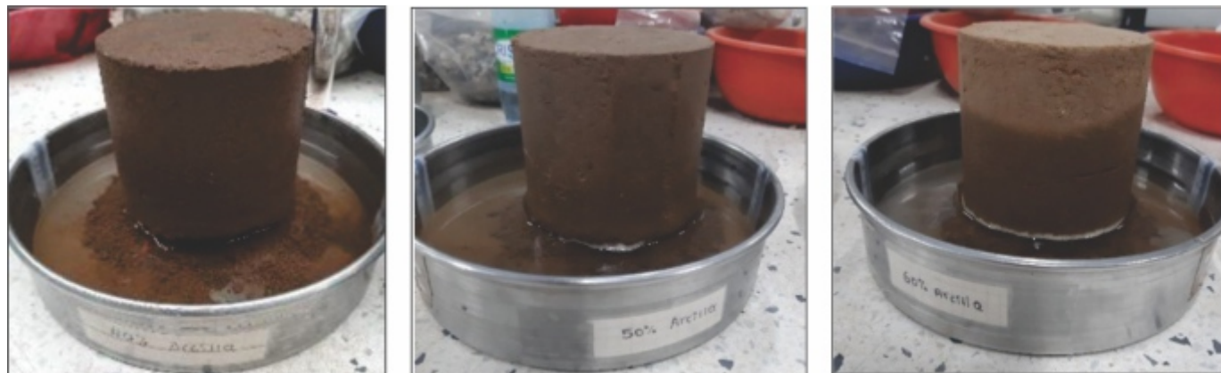
Figura 6. Absorción en mezclas de suelo – arcilla.
