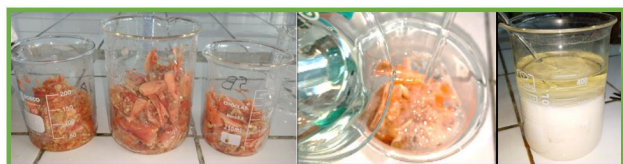
Figura 4. Obtención de quitosano a partir de exoesqueleto de camarón
