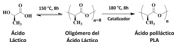
Figura 2. Proceso de obtención de ácido poliláctico por policondensación por fusión.
