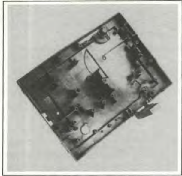
Figura 3. Base de un proyector de diapositivas de PC reforzado con fibra de vidrio (Makrolon 8324)
