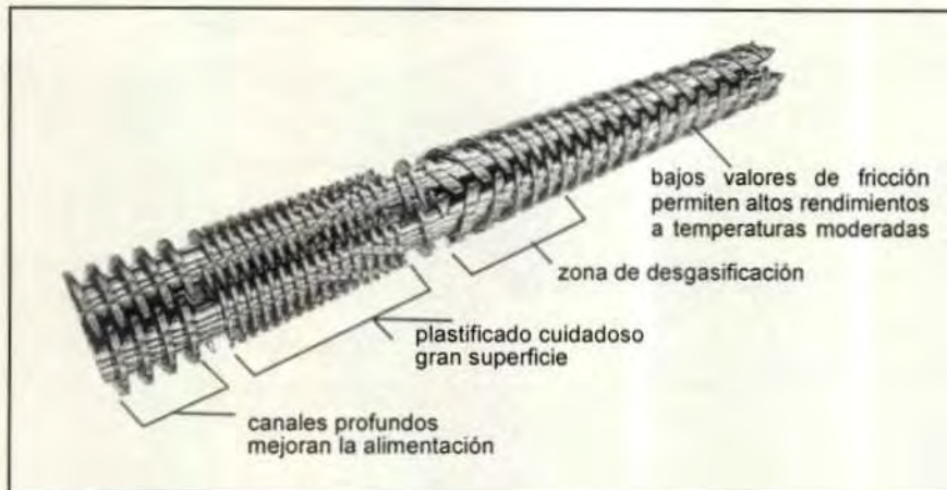
Figura 6. Doble tornillo cónico
