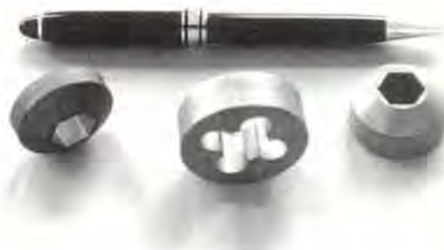
Figura 4. Piezas obtenidas a partir de las matrices diseñadas tras la sinterización en atmósfera industrial
