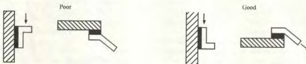
Fig. 3 Uniones de sujeción que muestran buenas y malas prácticas
