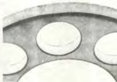
Fig. 7 Pieza de trabajo de troquelado de precisión, fabricada con útiles interiores recubiertos con Balnit y útiles exteriores sin recubrimiento.
