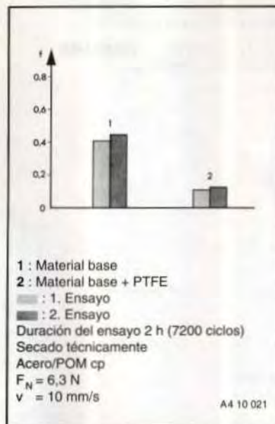
Figura 6. Coeficientes de fricción f de deslizamiento acero/POM cp y acero/POM cp + PTFE con un movimiento de deslizamiento oscilante (aparato de
