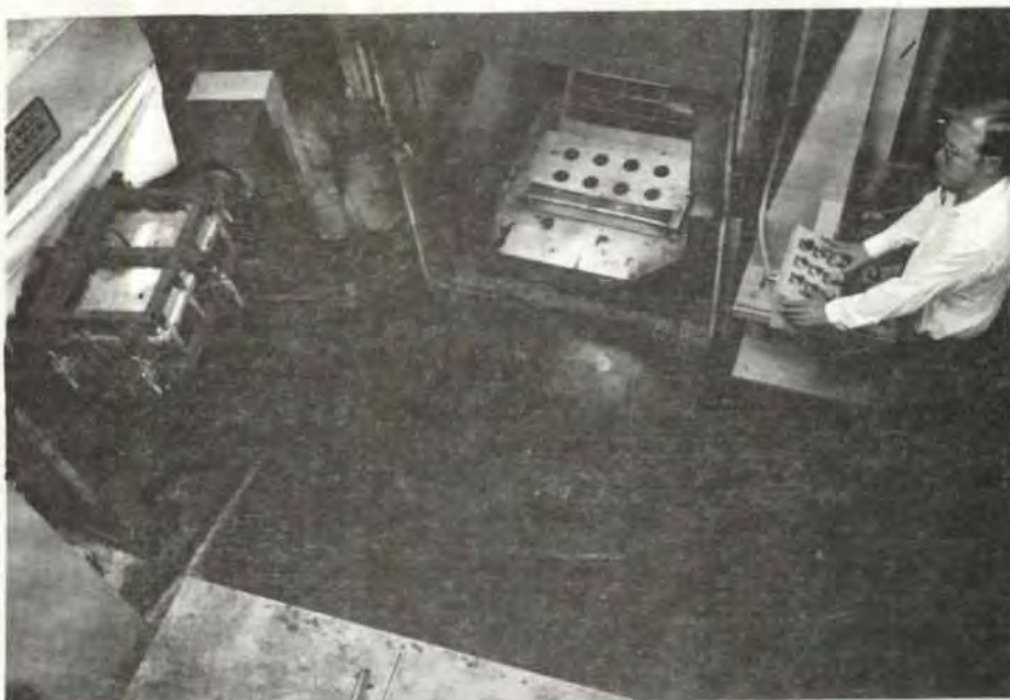
Figura 3. Rotación del molde en el canal de enfriamiento después del ciclo de horneado.
