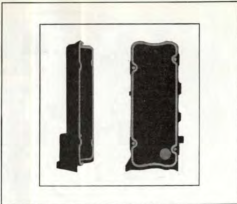
Gráfica 5: Sección de una pieza moldeada de pared gruesa
