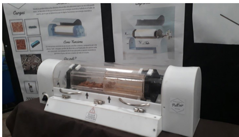
Figura 3. Prototipo de máquina pulidora de joyas.
