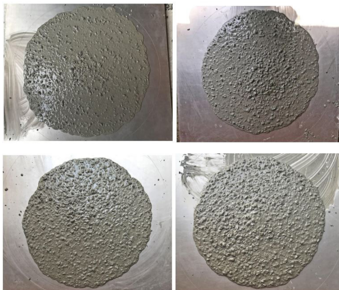
Figura 6. Ensayo de flujo de asentamiento mediante cono de Abrams, (de izquierda a derecha, mezcla patrón, F-10 %, F-20 %, F-30 %).
