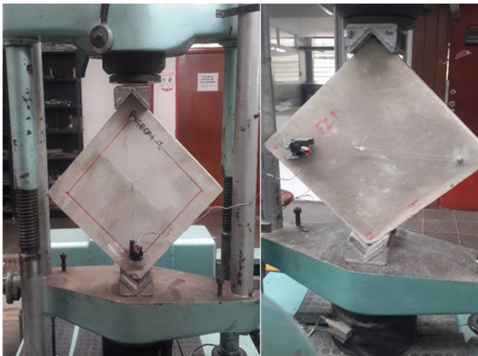
Figura 6. Ensayo realizado a muretes de CAC Fuente: elaboración propia.
