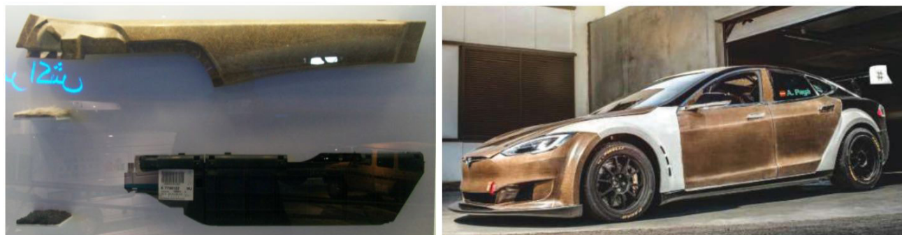
Figura 3. Partes automotrices fabricadas en compuesto polímero y fibras de coco (Izq). Carrocería prototipo en fibras de cáñamo en vehículo Tesla (Der) Fuente: Midani (2019).
