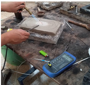
Figura 1. Prueba de capacidad de aislamiento del PAPERCRETE Fuente: elaboración propia.
