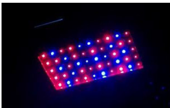
Figura 5. Prueba PCB del panel LED.
