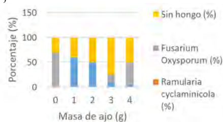
Figura 1. Porcentaje de área de distribución de los hongos en los cultivos, en función de la cantidad de ajo adicionado como inhibidor durante la fabricación del biopolímero.
