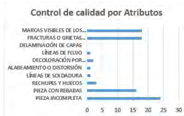
Figura 3. Control de calidad de las probetas inyectadas.
