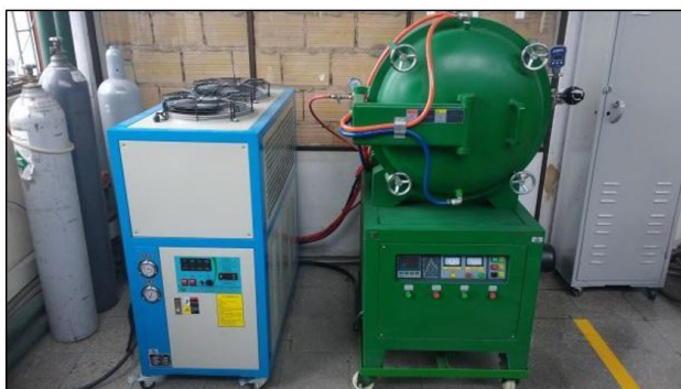
Figura 6. Horno eléctrico de sinterización PT-V1700 34L.
