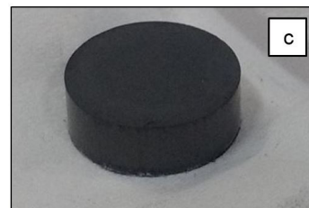
Figura 5. (a y b) Adición y compactación del polvo respectivamente y (c) Probeta cilíndrica en estado verde
