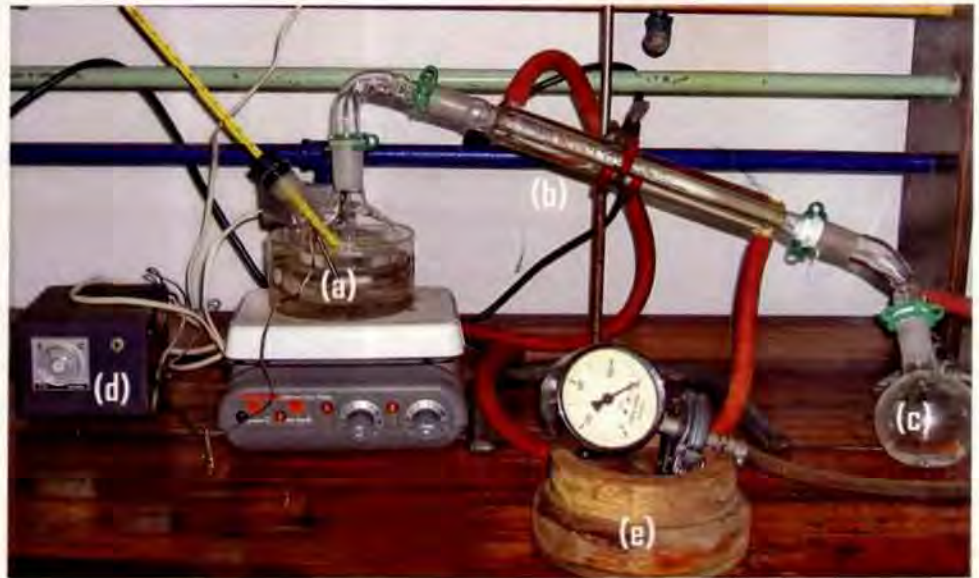
FIGURA 1. Equipo de destilación usado para polimerizar el ácido láctico: El montaje consta de: a) Un balón de dos bocas donde se introduce el ácido láctico, b) un condensador que permite el flujo de agua para eliminar el subproducto, c) un balón de una boca donde se deposita el agua eliminada, d) un controlador de temperatura y e) un equipo para reducir la presión y cuantificarla.
