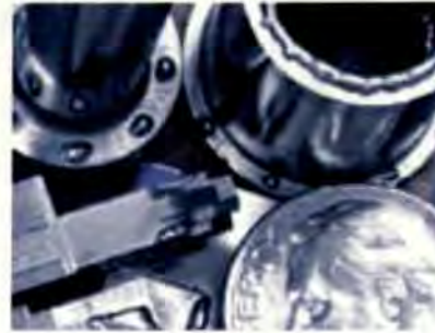
Fig 2 Conjunto de piezas con aplicación de soldadura TIG micro controlada.
