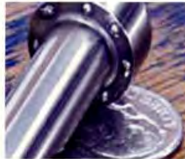
Fig 3 Reparación de la cabeza de un pin macho de 1/4" de diámetro. Las soldaduras están en el reborde circundante de la cabeza del pin.
