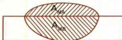
Figura 3. Determinación de los valores de A_{MB} y A_{MA} . Mediante el programa Autocad 2007.
